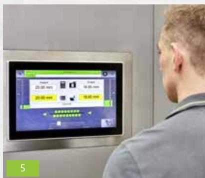
**Интуитивно понятный пользовательский интерфейс** ускоряет процесс ввода настроек для различных материалов на правильном станке. Современный сенсорный дисплей позволяет оператору машины вводить, сохранять и перезагружать параметры правки.
