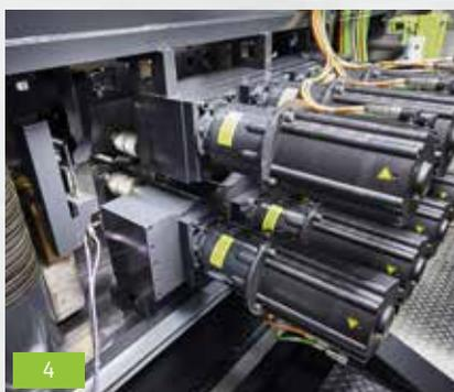
**Прямой привод** обладает многочисленными преимуществами: высокая энергоэффективность, пониженный уровень износа правильных валов, низкий уровень шума, большие обрабатываемые толщины, более высокое качество обрабатываемой поверхности, повышенный крутящий момент на правильных валах.
