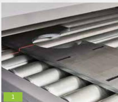
**Функция реверса** обеспечивает возможность загрузки и разгрузки машины с одной стороны. После выполнения операции правки автоматически поднимается верхний блок валков, изменяется направление вращения правильных валов, и обрабатываемая деталь возвращается в зону загрузки.
