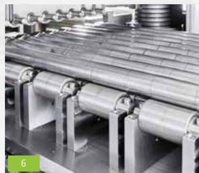
**Широкие опорные ролики** обеспечивают надёжную поддержку правильных валов за счет большой длины линии контакта – около 50% от общей длины правильных валов. Преимущества: высокая надёжность, более высокое прилагаемое усилие, меньший износ валов и высокая повторяемость результатов правки.
