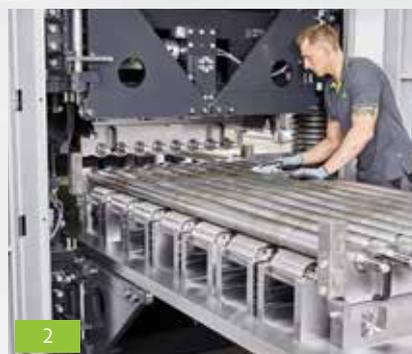
**Усовершенствованная система очистки** упрощает очищение правильных и опорных валков благодаря полностью выдвижной кассете.
